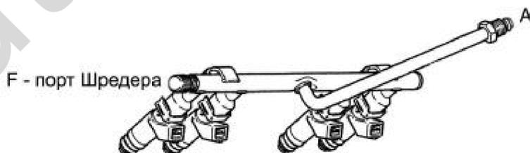
Например, топливная рампа автомобилей семейства ВАЗ-2108, 2109, 2110, 2111 – 2115 имеют в своей конструкции обратную ветвь. Пример данной топливной рампы приведем ниже
