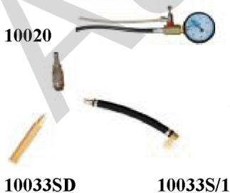
2 шаг - Соединение адаптеров с манометром и топливной планкой с краном и проведение замеров
